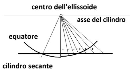
Se invece di proiettare su un cilindro tangente si proietta su un cilindro secante
