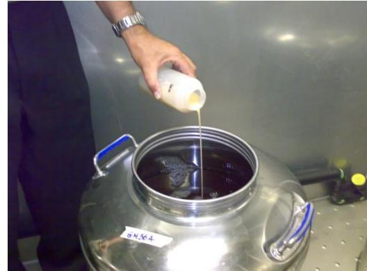
Inoculo delle cellule di lievito ( $> 5 \cdot 10^6$  CFU/ml) in tank da 70 L a 18°C
