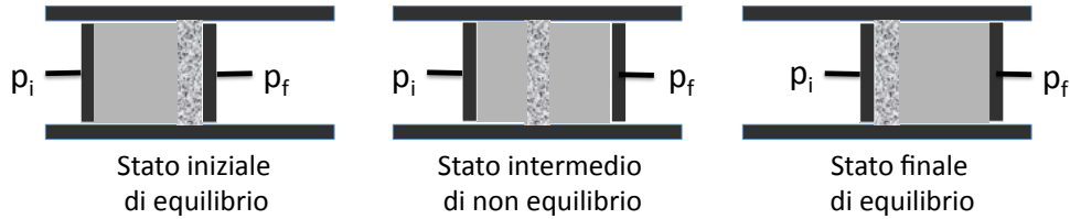
Figura 10.3: Rappresentazione schematica dell'effetto Joule-Thomson. A sinistra lo stato di equilibrio iniziale, con tutto il gas a sinistra del setto poroso. A destra lo stato di equilibrio finale, con tutto il gas a destra del setto poroso. Gli stati intermedi non sono stati di equilibrio; la trasformazione non è reversibile.
